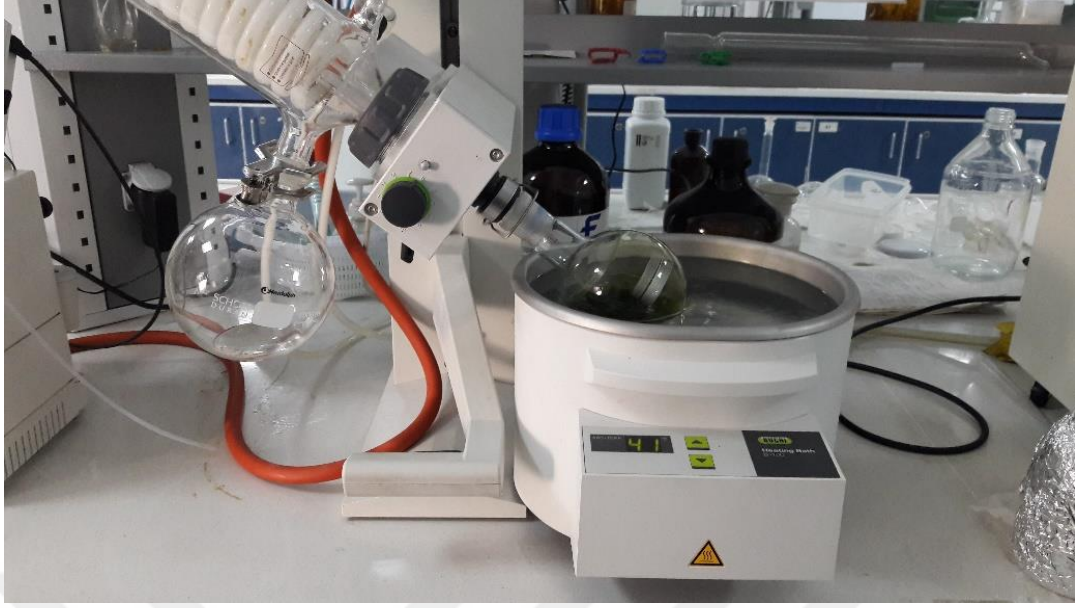
Şekil 3.5. Evaporatör ile metanollü kısmın uzaklaştırılması
