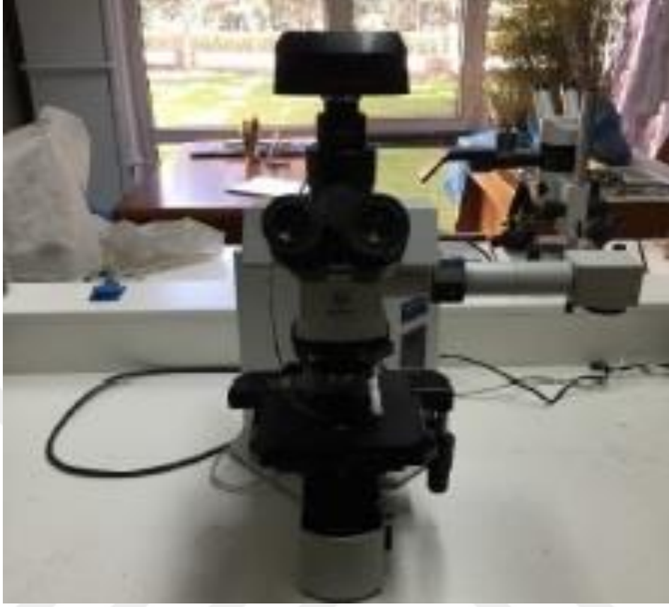
Şekil 3.4. Trinokuler mikroskop ve Kameram görüntüleme sistemi
