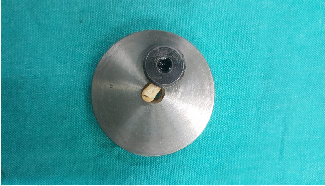
Şekil 3.6 Örneklerin yerleştirildiği metal kaide
