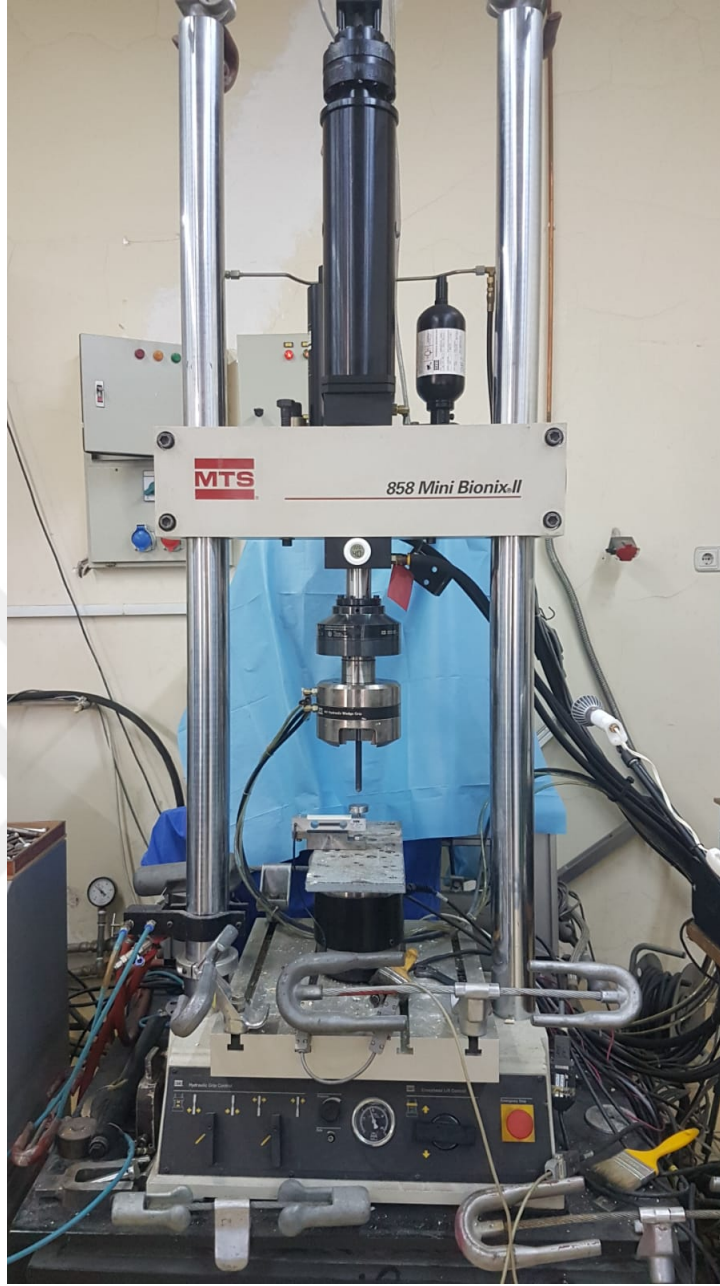
Şekil 3.7 Deneylerde kullanılan bilgisayar kontrollü test cihazı
