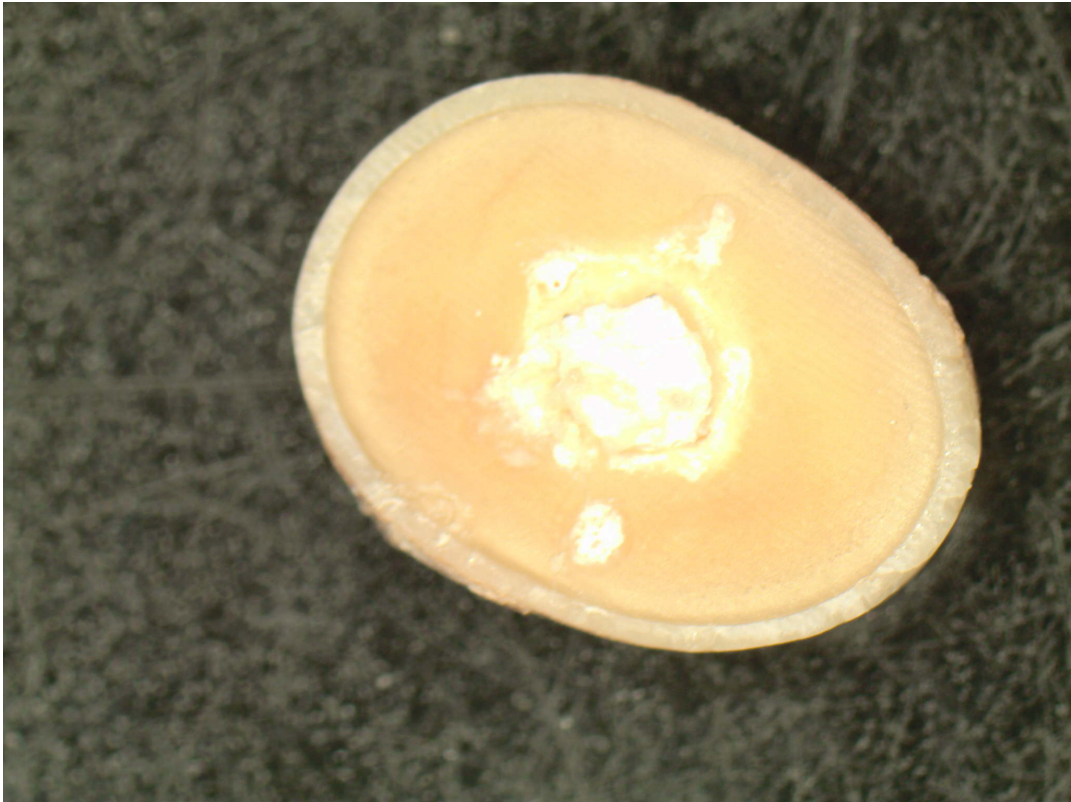
Şekil 4.8. 4 gün pH 4.5 + 30 gün PBS solüsyonunda bekletilmiş ERRM örneği
