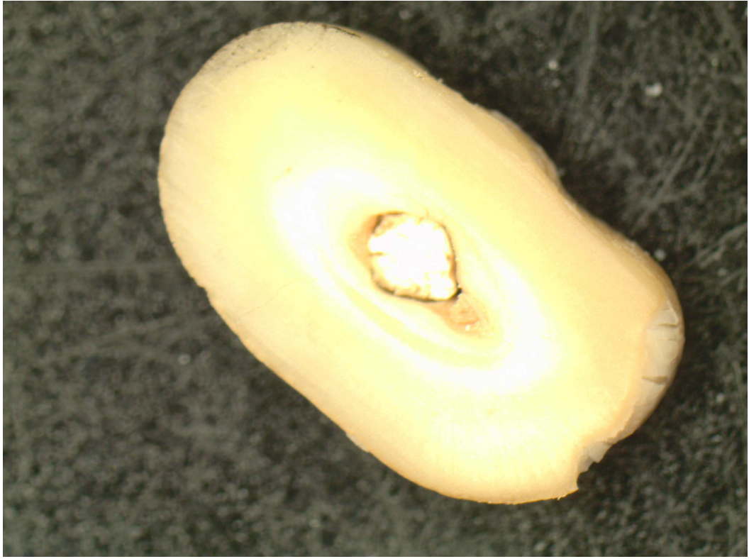
Şekil 4.12. 4 gün pH 4.5 + 30 gün PBS solüsyonunda bekletilmiş Biodentine örneği
