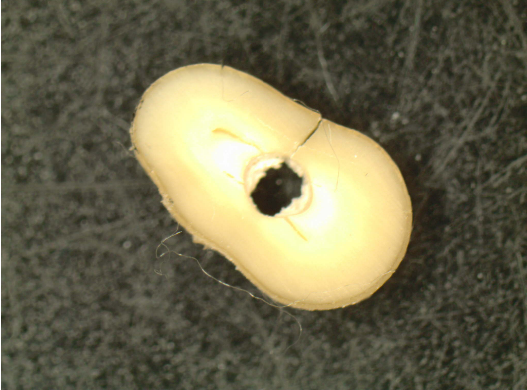
Şekil 4.16 4 gün pH 4.5 + 30 gün PBS solüsyonunda bekletilmiş BioMTA örneği
