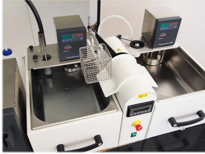
Resim 18: Örneklerin ısı döngü işlemi ile yaşlandırılması
