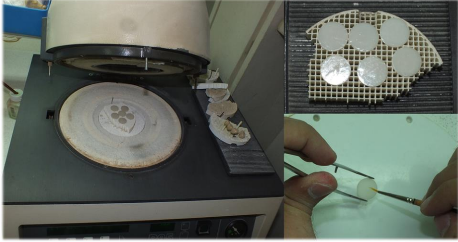
Resim 30: Renk analizi örneklerine IPS e.max® Ceram Glaze ile glazür uygulanması
