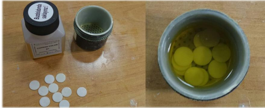
Resim 29: Monolitik zirkonya örneklerin renklendirilmesi
