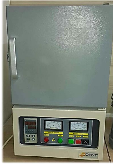
Resim 11: Monolitik zirkonya örneklerin sinterizasyonu
