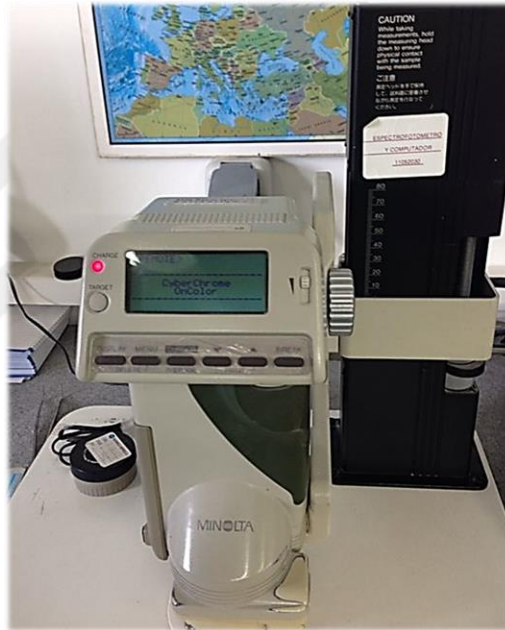
Resim 35: Renk örneklerinin ölçümlerinin CM-512M3, Minolta spektrofotometre ile yapılması
