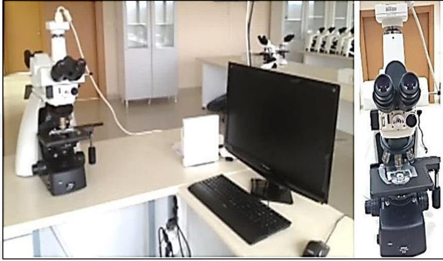
Resim 4. Nikon DS-Fi 2 / DIGITAL SIGHT DS-U 3 marka dijital kamera monte edilmiş Nikon ECLIPSE marka ışık mikroskobu
