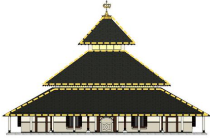
Ahşap yapı üzerinde üç katlı geleneksel "tumpang" çatı,
