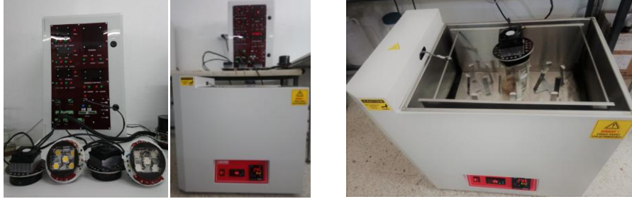
Şekil 3.1. UV A LED – UV C ve Görünür LED lambaların kontrol paneli ve reaktör düzeneği
