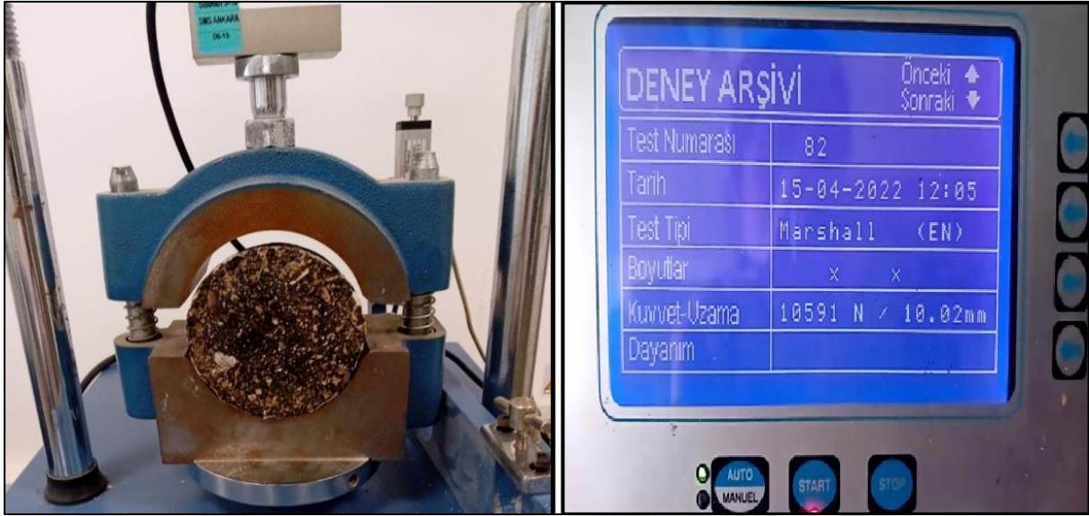
Şekil 3.18. Numunelerin stabilite ve akma dayanımının ölçülmesi
