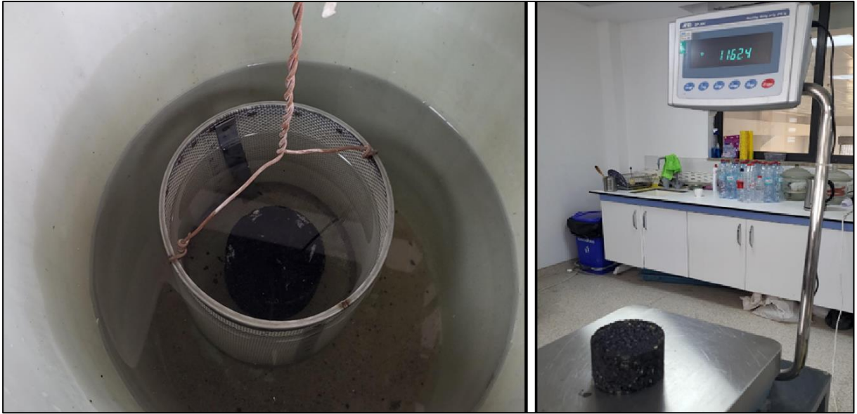
Şekil 3.16. Marshall numunelerinin suda ve havada tartımları
