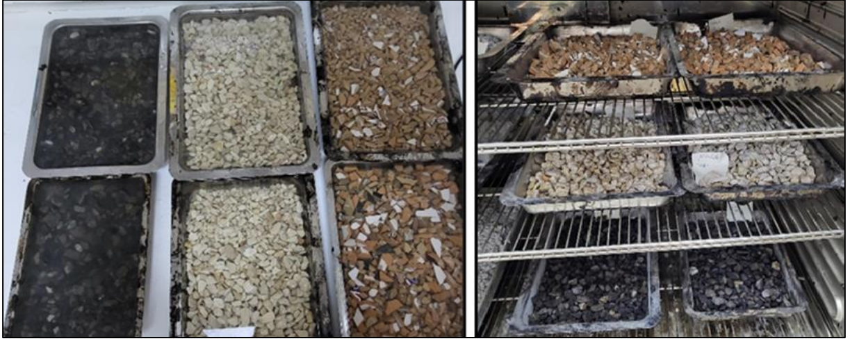
Şekil 3.12. Agregaların 24 saat suda bekletilmesi ve etüvde kurutulması
