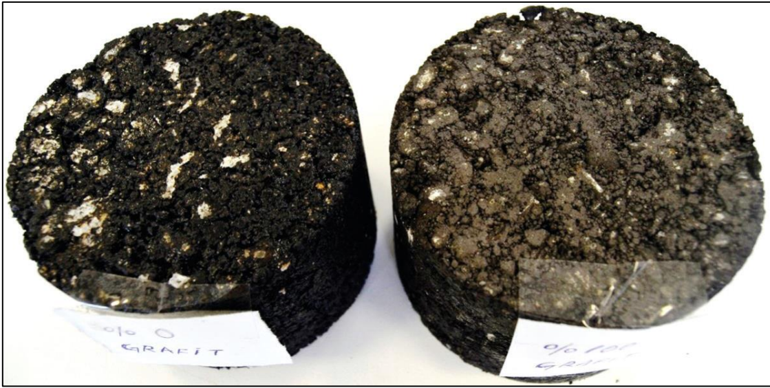
Şekil 4.4. %0 grafit tozu (sol) ve %100 grafit tozu (sağ) içeren asfalt numuneler
