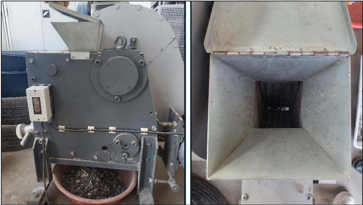
Şekil 3.4. Çalışmada kullanılan atık camların öğütülmesinde kullanılan çeneli kırıcı aleti
