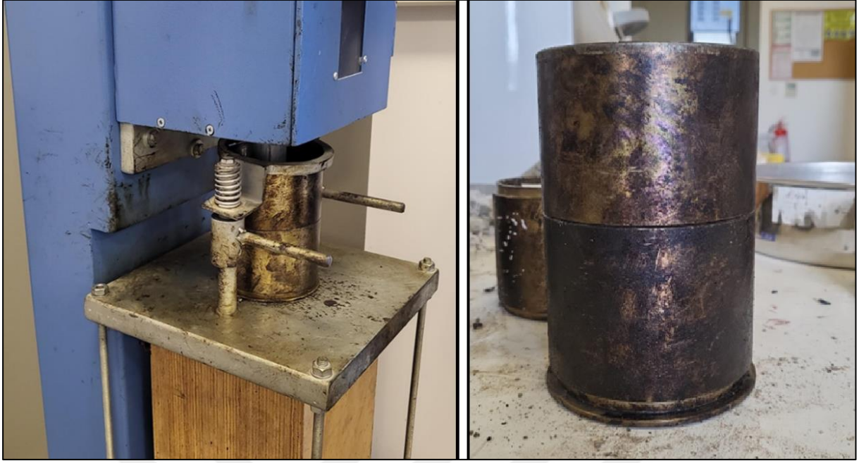
Şekil 3.15. Marshall numune kalıbı ve otomatik tokmak
