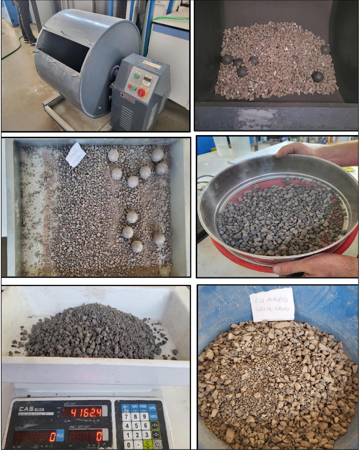
Şekil 3.14. Los Angeles (Aşınma) deney aşamaları
