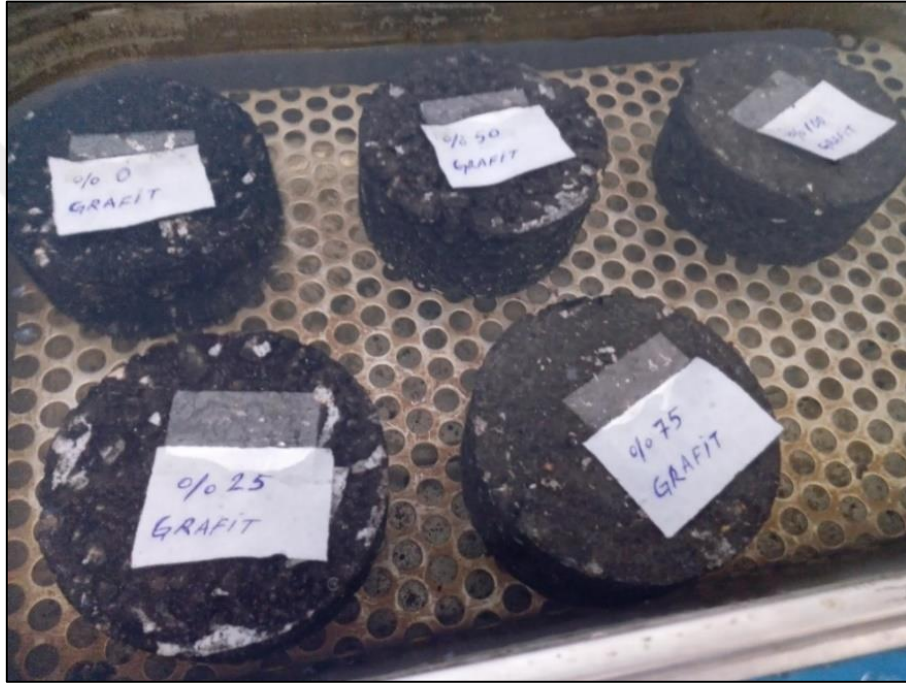
Şekil 3.17. Marshall numunelerinin kür havuzunda şartlandırılması
