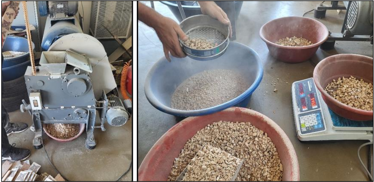
Şekil 3.6. Atık seramiklerin çeneli kırıcıda öğütülmesi ve elenerek gradasyonlara ayrılması
