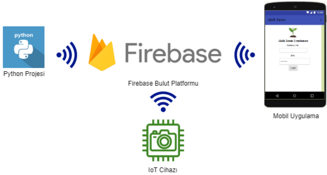
Şekil 4.11 IoT sistemi mimarisi
