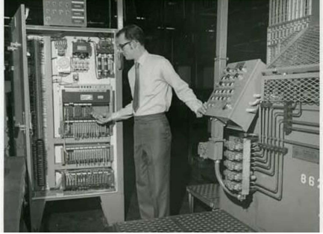
Görsel 1.5. General Motors firması tarafından üretilen ilk PLC 1968 ( http-5 )
