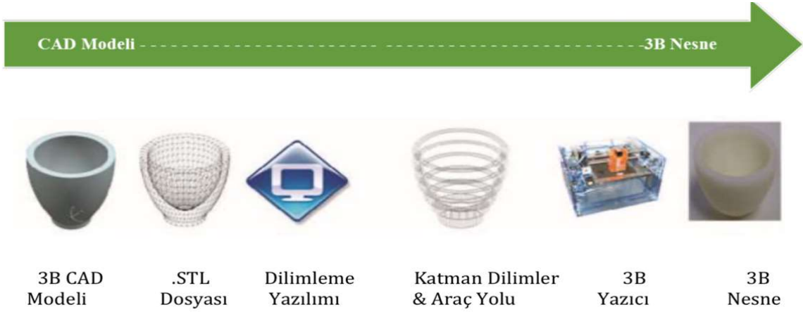
Şekil 1.3. 3D yazıcı ile üretim süreci
