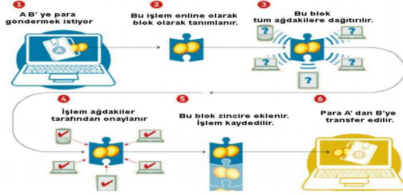
Şekil 3.8. Blok zincir çalışma mantığı (Crosby ve ark., 2016)
