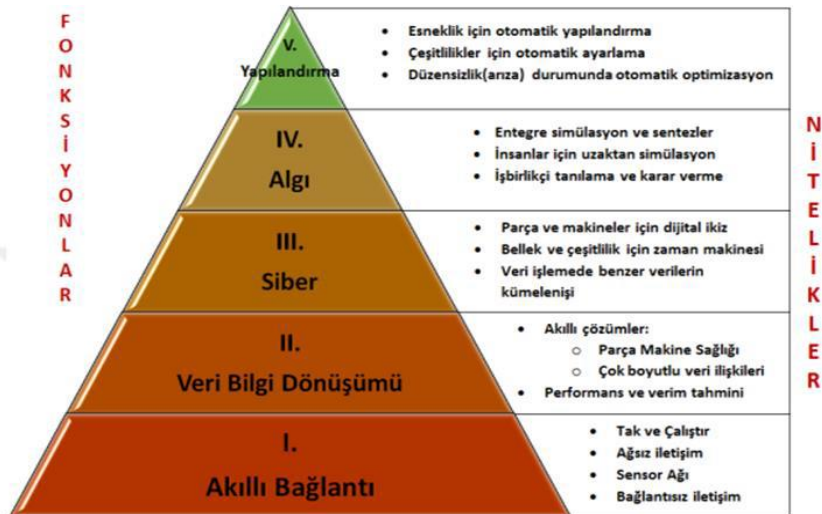
Şekil 3.11. Siber-Fiziksel sistemin uygulanması için 5c mimarisi (Lee ve ark., 2015)
