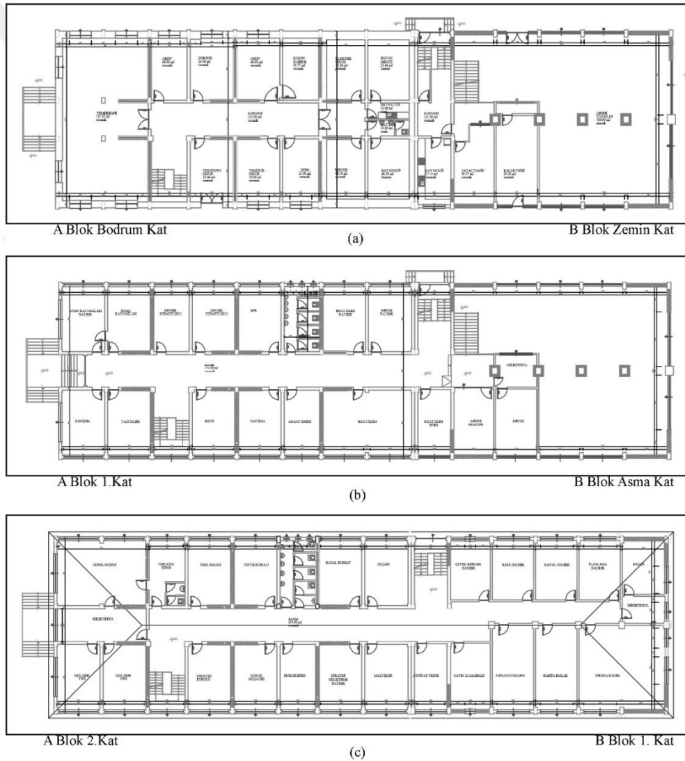
Şekil 5.34. Orjinal TZDK teknik servisler binasının SASKİ olarak dönüşüm projesi, (a) bodrum ve zemin kat planı, (b) asma kat ve birinci kat planı, (c) birinci ve ikinci kat planı (Erdal Yıldırım Mimarlık)
