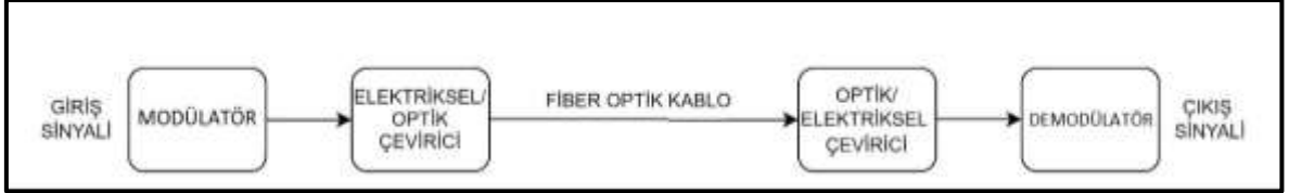
Şekil 2.3. Fiber optik kablonun sistemde bulunduğu yer örneği
