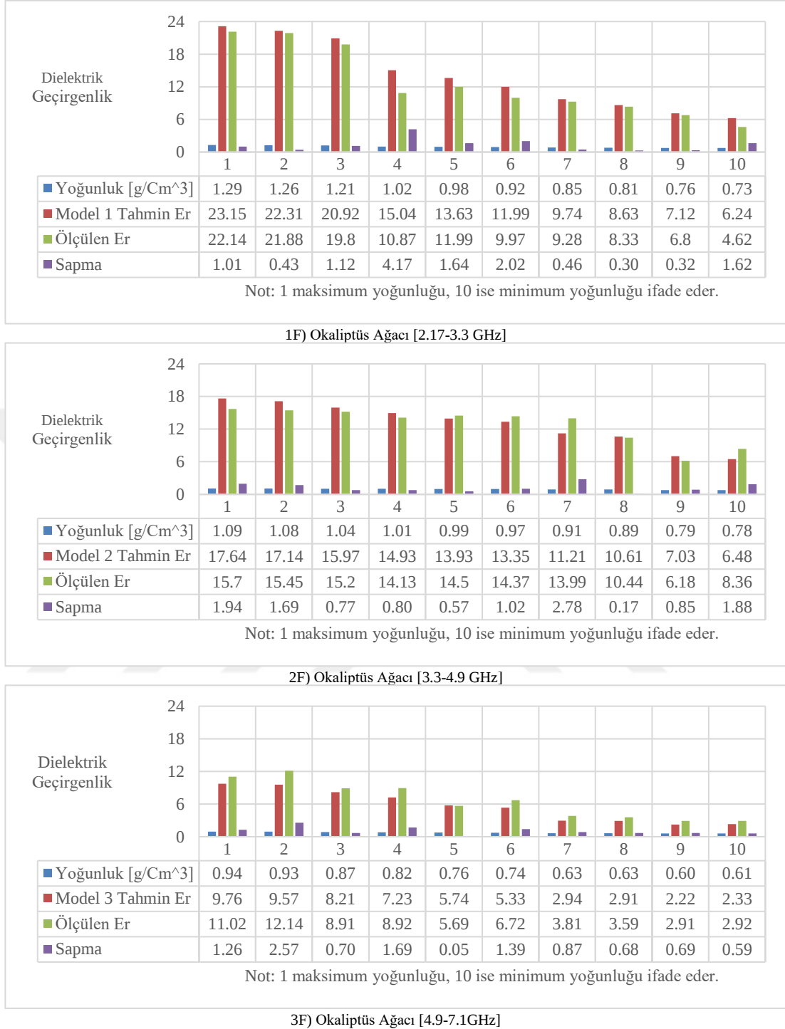
Şekil 4.9. Sert ağaç örnekleri deneysel modellerin değerlendirilmesi
