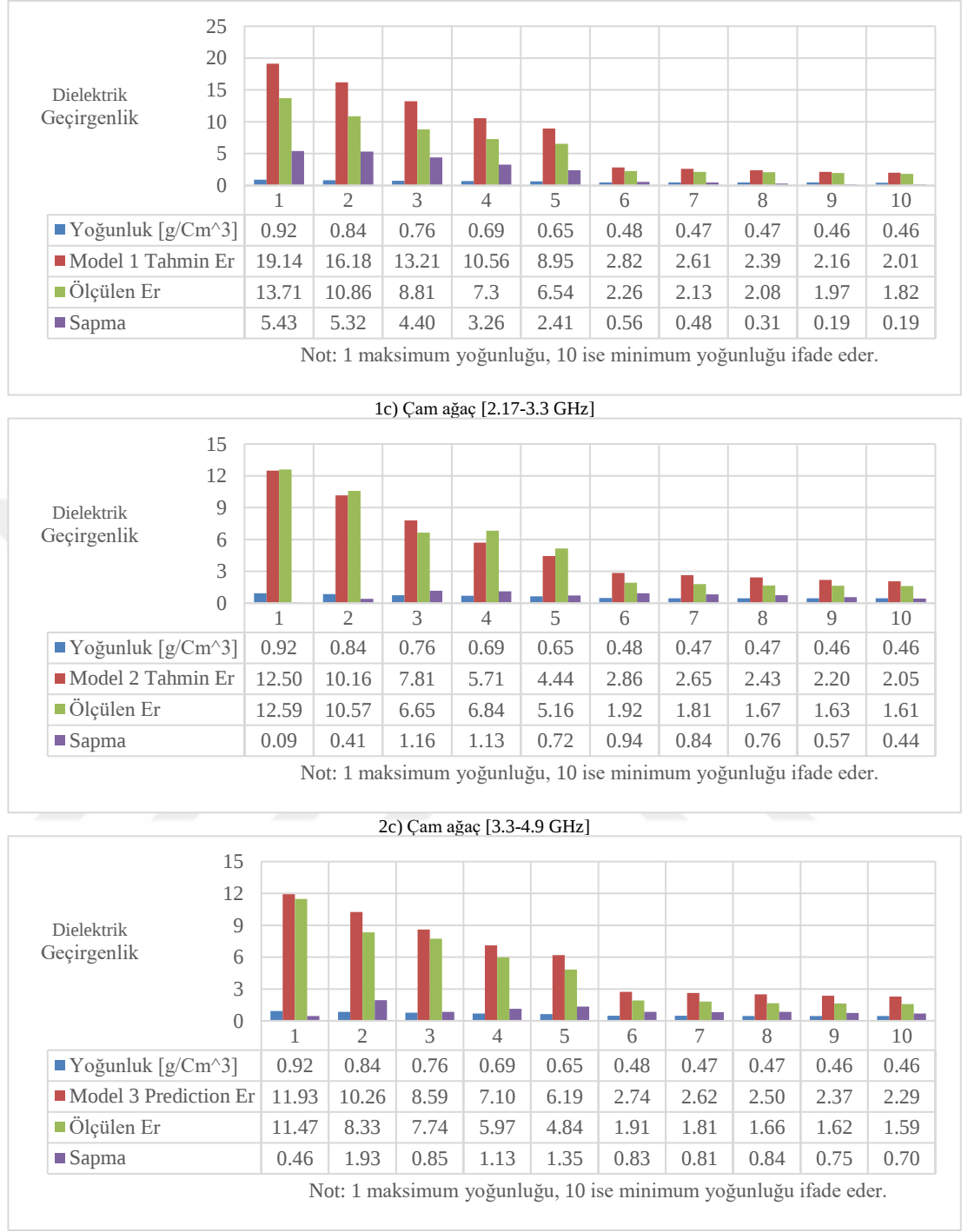
Şekil 4.4. Yumuşak ağaç örnekleri deneysel modellerin değerlendirilmesi
