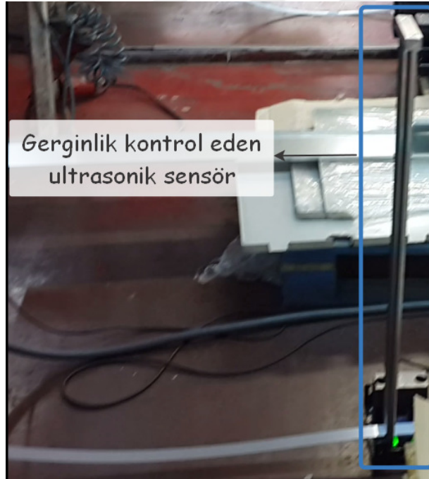
Şekil 3.2. Rulo Açıcı Önündeki Loop Mekanizması
