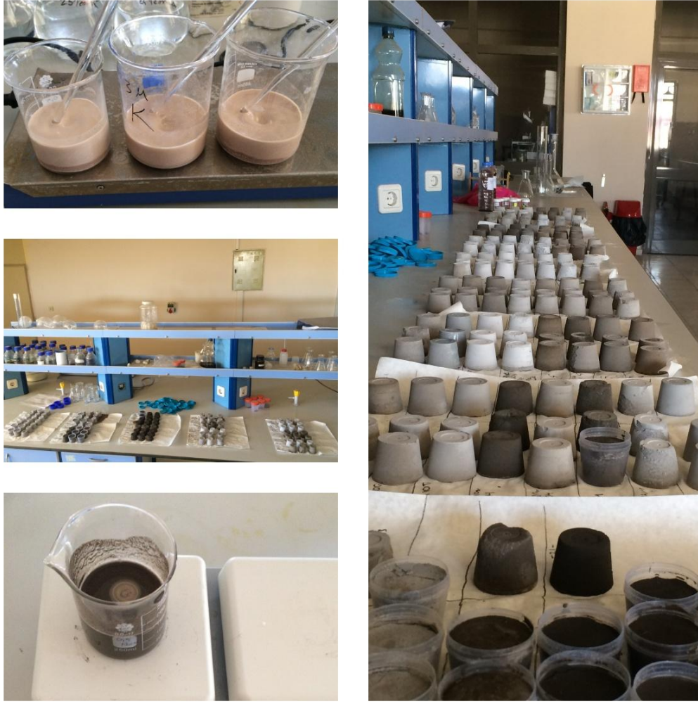
Şekil 4.3 Geopolimerin harcının hazırlanması ve kalıplanması işlemleri.
