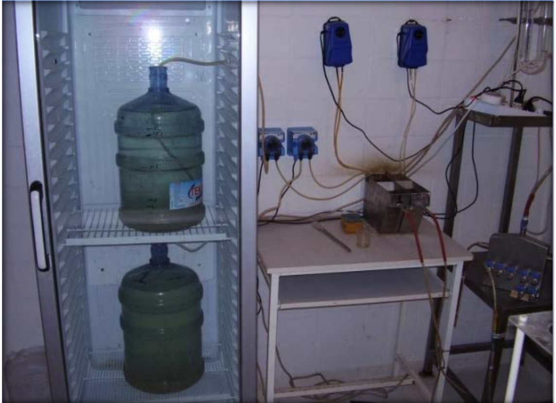
Şekil 3.7. Kullanılan sürekli beslemeli YAÇYR geri döngüsünde aerobik BKR sistemi
