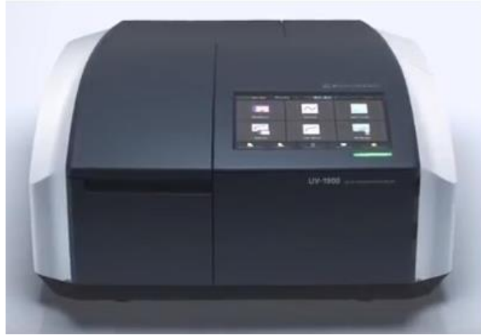
Şekil 3.5. UV-vis spektrofotometre (Shimadzu UV-1900i) cihazı
