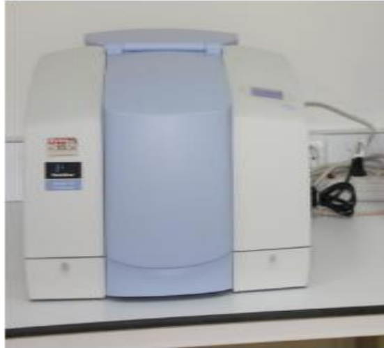
Şekil 3.2. Perkin Elmer Spectrum 100 marka FT-IR cihazı
