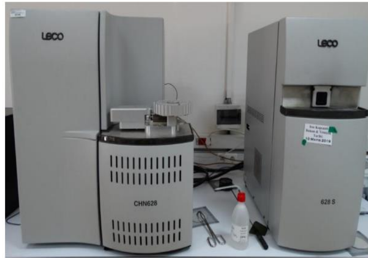
Şekil 3.4. Leco marka CHNS 628 model elementel analiz cihazı
