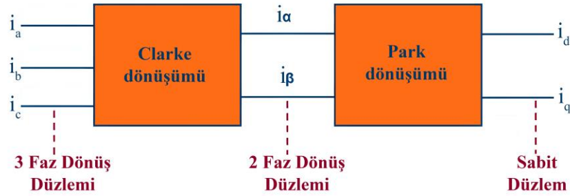
Şekil 2.18. Clarke ve Park dönüşüm blok diyagramı (Çorapsız, 2018)
