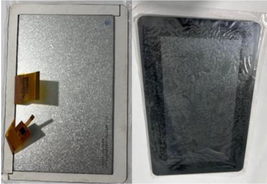
Şekil 3.6. Kullanılan LCD Panelin Montajdan Önceki Görüntüsü
