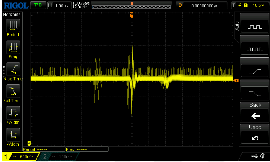
Şekil 4.4. V_{GH} Voltajı Osiloskop Görseli
