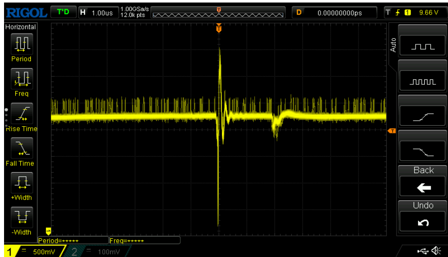
Şekil 4.5. AV_{dd} Voltajı Osiloskop Görseli
