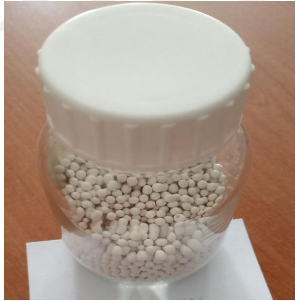
Şekil 2.2. Sulu Öğütmede kullanılan 2-3 mm boyutundaki alümina bilyeler
