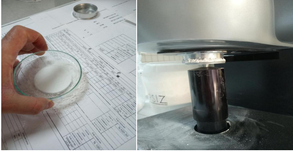
Şekil 2.5. Renk (beyazlık) analizi ölçümü
