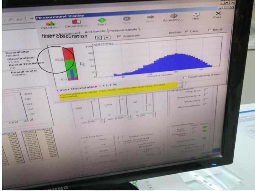
Şekil 2.3. Malvern tanecik boyutu ve dağılımı analizi
