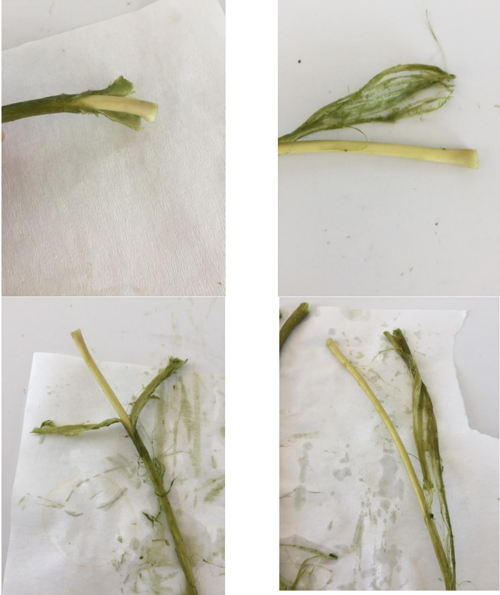
Şekil 3.24. Havuzlama işlemi sonrası liflerin gövdeden ayrılması
