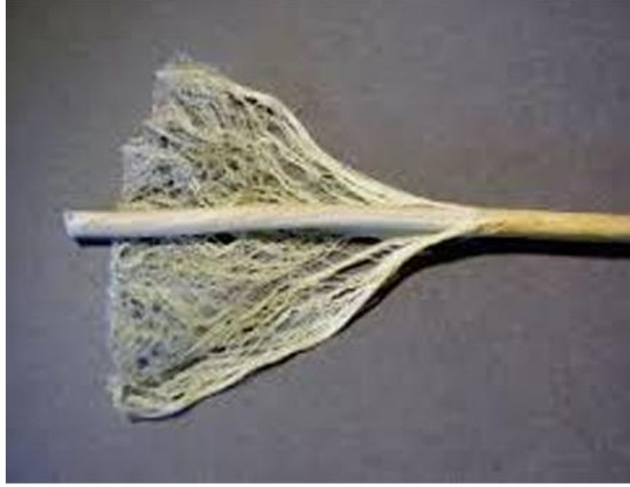
Şekil 2.6. Havuzlama işlemi sonrası liflerin gövdeden ayrılması (Gizlenci ve ark., 2019)
