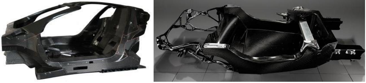
Şekil 2.13. Otomobil ve yarış aracı için karbon fiber kompozit kullanılarak üretilmiş karoser örnekleri (Kaynak:Compositesworld, Gardiner , 2014; Jec, Robathan, 2023)
