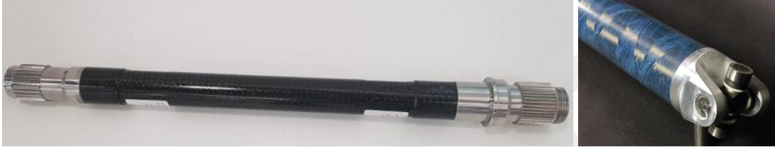
Şekil 2.14. Otomobil için karbon fiber kompozit kullanılarak üretilmiş şaft örnekleri (Kaynak:Adente, Ot, 2024; compositesworld, Black, 2017)
