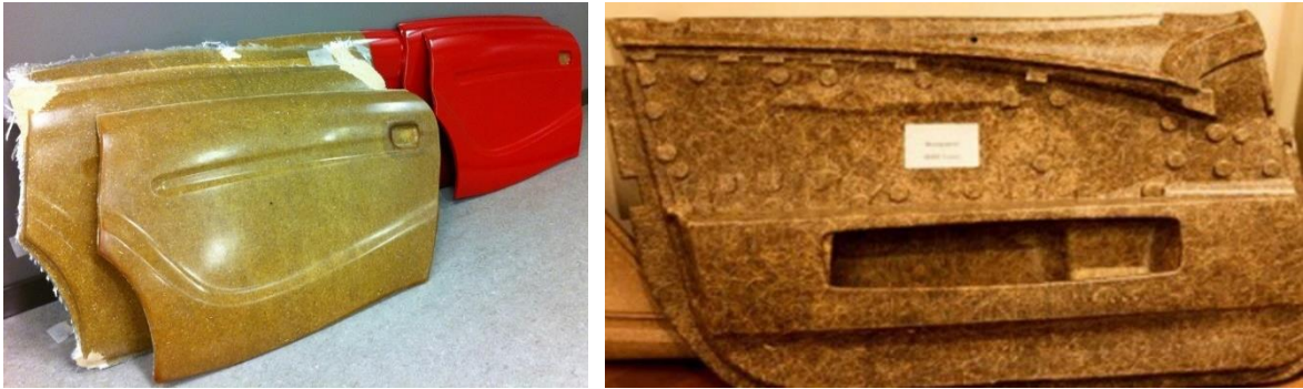
Şekil 2.15. Doğal liflerin takviye malzemesi olarak kullanılmasıyla üretilmiş biyokompozit örnekleri; otomobil kapı kaportası ve iç paneli (Kaynak:Cannabisdigest, Walsh, 2014; İmeche, Pe, 2015)
