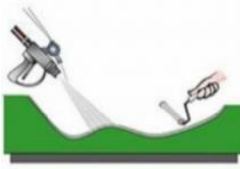
Şekil 2.6. Püskürtme yöntemi ile kompozit üretiminin şematik gösterimi (Kaynak: Bedir, 2006)
