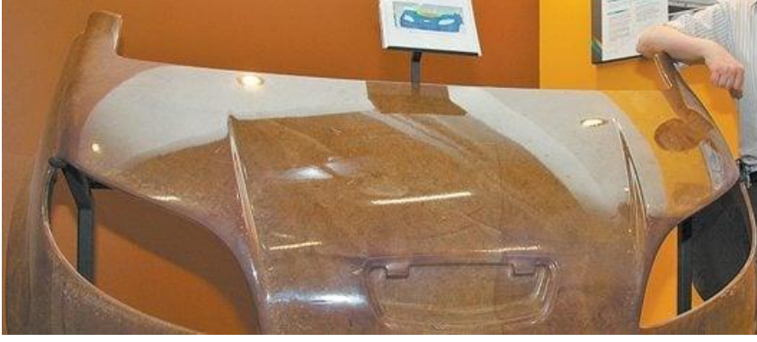
Şekil 2.16. Doğal liflerin takviye malzemesi olarak kullanılmasıyla üretilmiş biyokompozit kaput örneği (Kaynak: Producer, Arnason, 2012)
