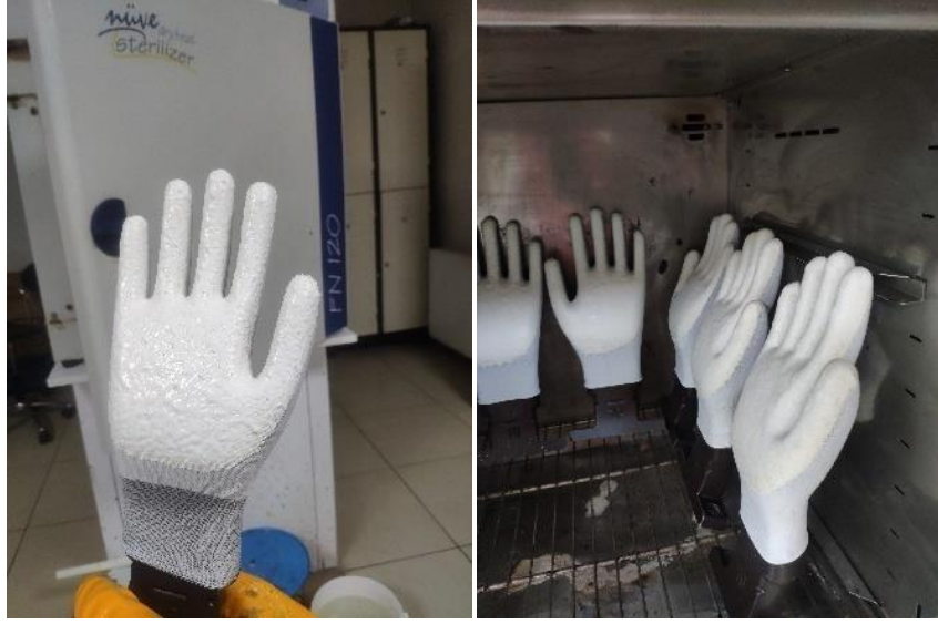
Şekil 4.3. Kompozit yüzey kaplaması ve etüvde kürlenme aşaması.
