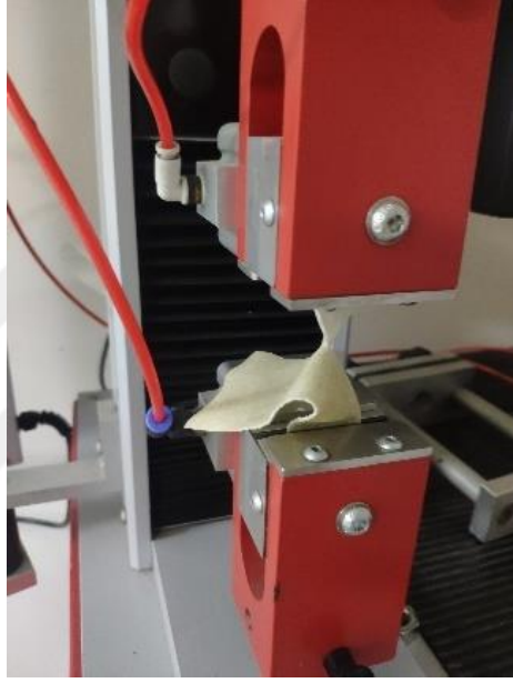
Şekil 4.6. Yırtılma test cihazı ve testin uygulanması.
