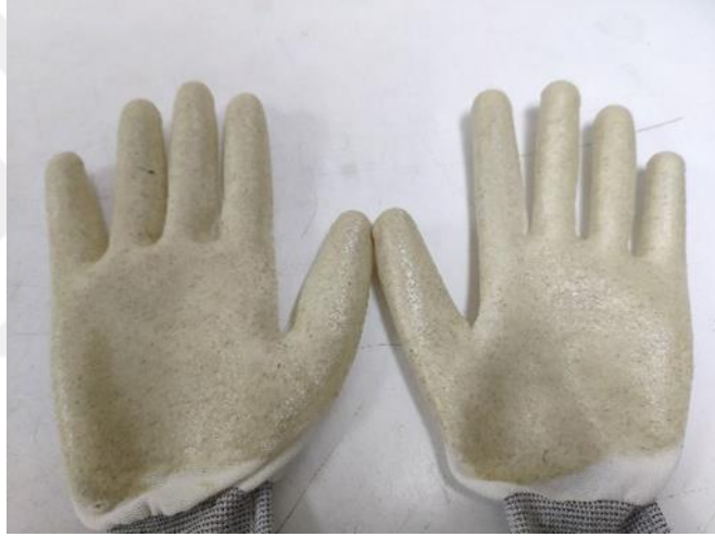
Şekil 4.4. Kompozit kaplama uygulanmış ve kürlenmiş eldivenler.
