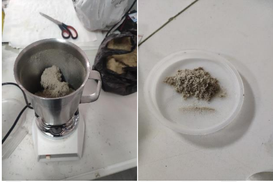
Şekil 4.1. (devam). Kenevir elyafın boyutunun küçültülmesi.
