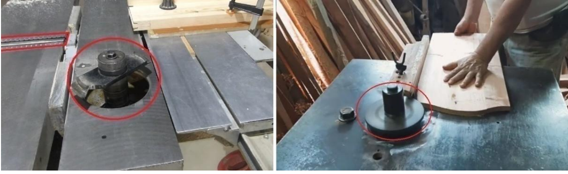
Şekil 3.19 Dairesel ve dikdörtgen tehlikeli bölgeler freze, planya
