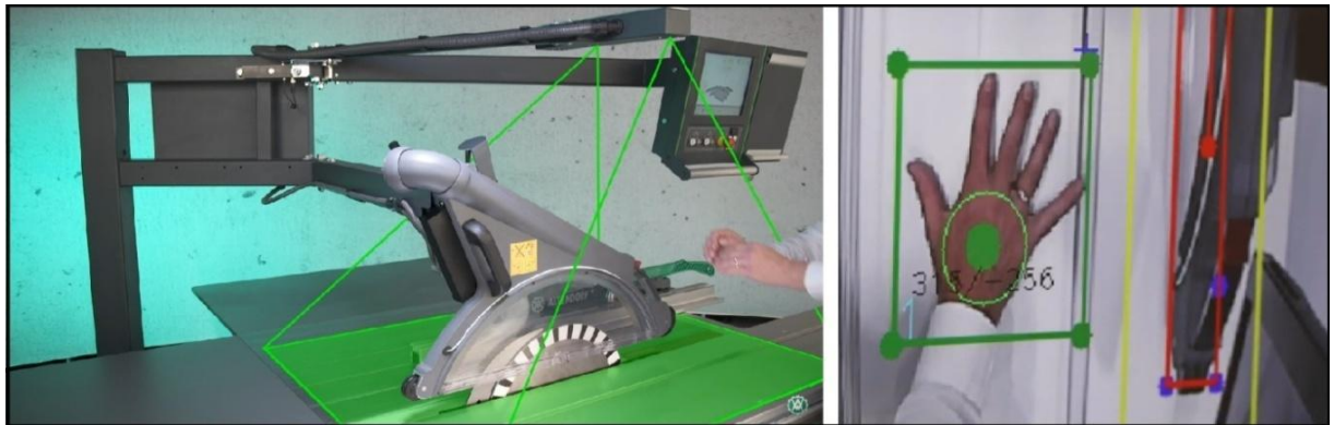
Şekil 2.2 Görüntü işleme ve yapay zeka yaklaşımıyla geliştirilen Altendorf Hand Guard sistem
