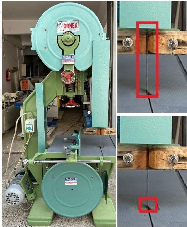
Şekil 3.20 Şerit testere için tehlikeli kırmızı bölge
