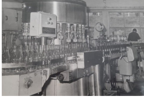
Şekil 5.7. Niksar Ayvaz Memba Suyu Cam Şişeleme Dolum Tesisinde Üretim (İşletme Eski Çalışan Arşivi/Personel 1)
