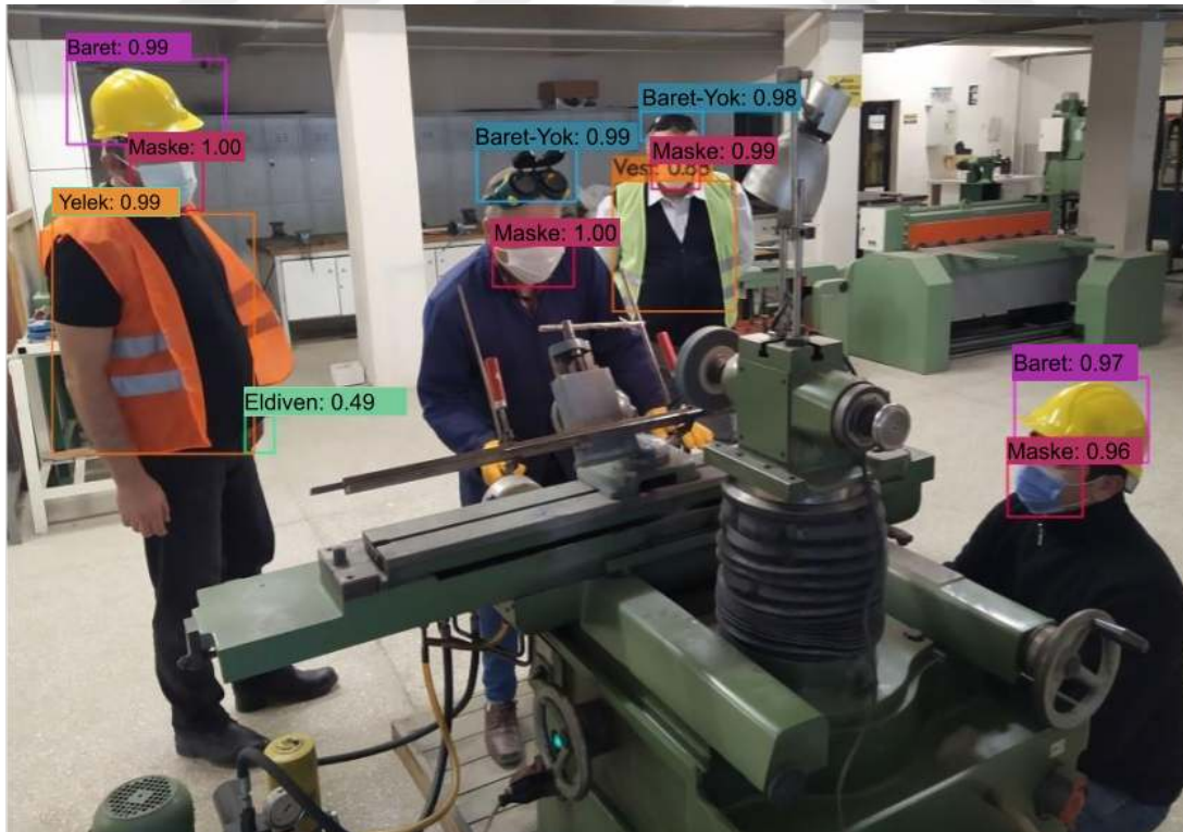
Şekil 4.2. İş sahasından alınan durağan bir görüntüde önerilen YOLOv4 mimarisi ile KKD tespiti yapılması
