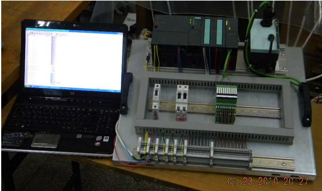
Resim 3.1. PNIO sistemin genel görünümü: (a) erişim düğümü, (b) istemci düğümü
