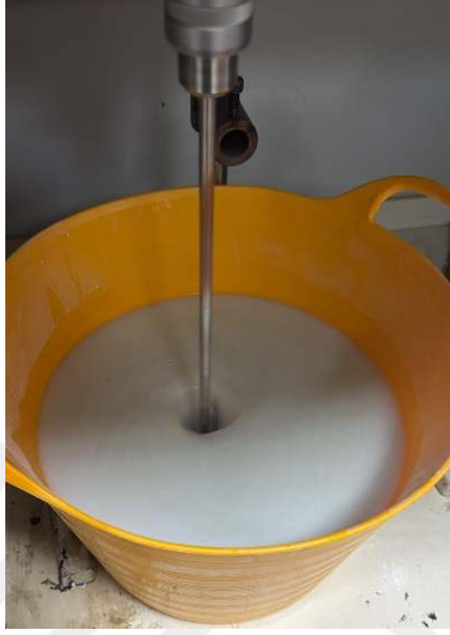
Şekil 9. Epoksi reçine atığının hazırlanan silane çözeltisinde karıştırılması
