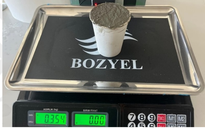
Şekil 13. Taze çimento harcının birim hacim ağırlık değerinin belirlenmesi
