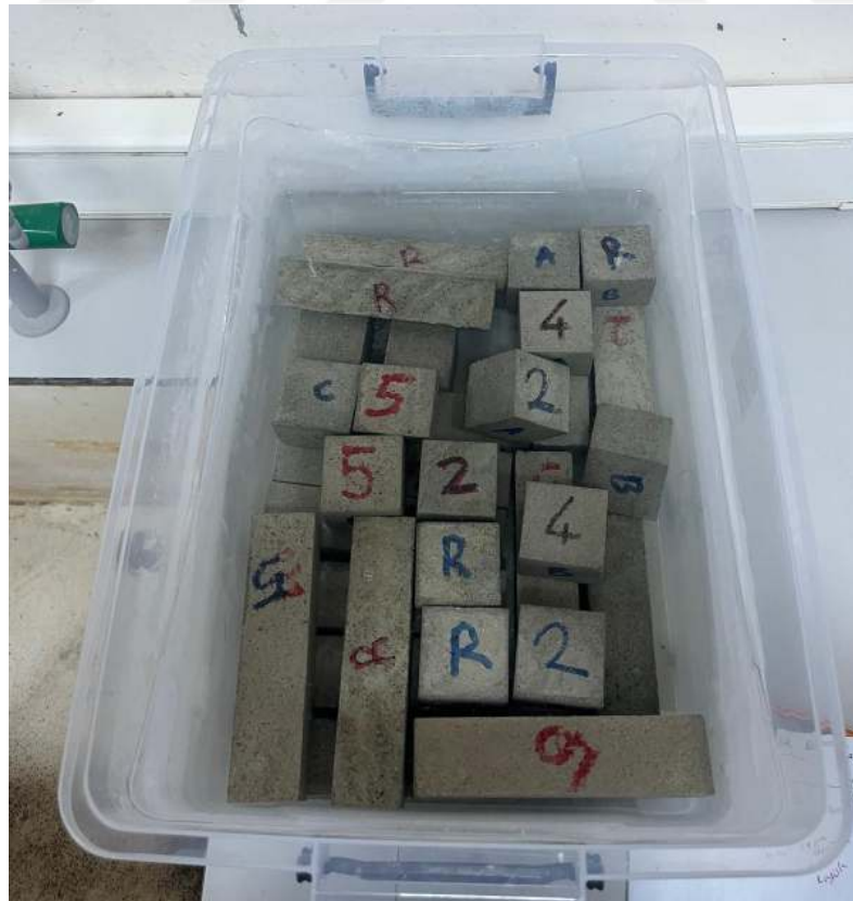
Şekil 12. Çimento harçlarının suda kürlenmesi
