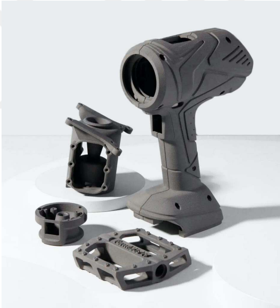
Görsel 4.7. SLS teknolojisi prototip örneği ( Fuse 1 SLS Materials: Nylon Powders )
