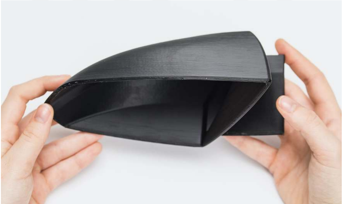
Görsel 4.5. FDM teknolojisi prototip örneği (Artley)
