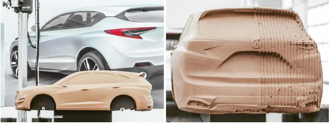
Görsel 4.3. CNC işleme ile üretilen görünüm modeli örneği (Noe, 2019)
