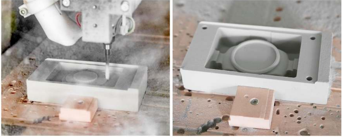
Görsel 4.2. CNC freze prototip üretimi
