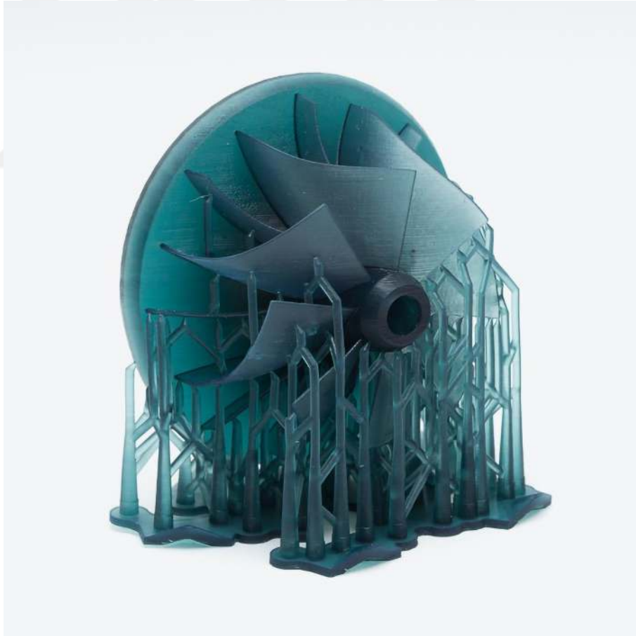
Görsel 4.6. SLA teknolojisi prototip örneği (Cain)
