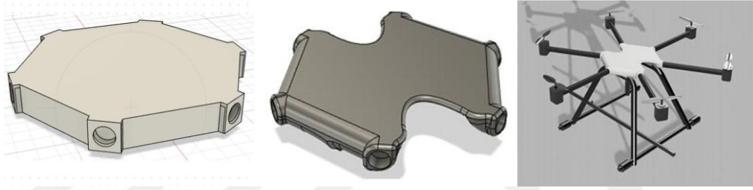
Şekil 1.12: Kütlesi %52,4 azaltılan Dron gövdesi (Gafurzade, 2022).
