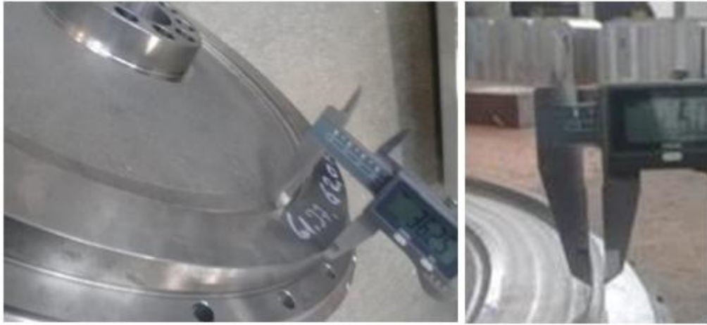
Şekil 1.9: Ağırlığı %6,93 oranında azaltılan volan (Sırmalılar ve diğ, 2022).
