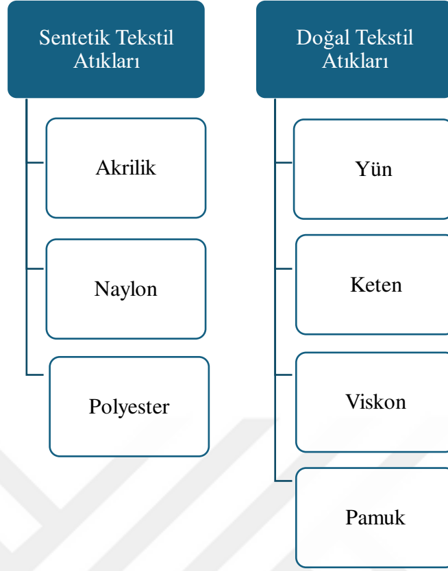
Şekil 2.7: Aktif karbon üretiminde kullanılan tekstil atık türlerini sınıflandırma şeması [57]
