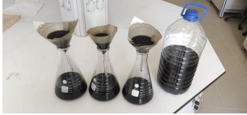
Şekil 3.1. Aksaray ili sızıntı suyunun 100 µm gözenek boyutuna sahip filtre kağıdından süzülümü.
