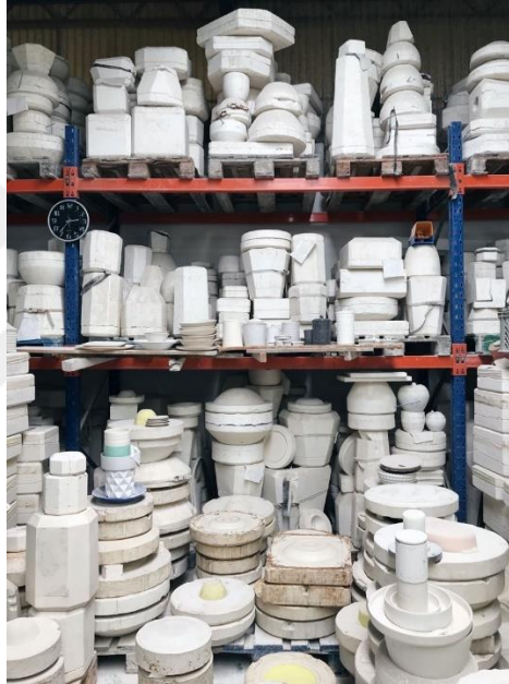
Görsel 2.19. Bir fabrikanın model, teksir ve iş kalıpları ( https://curateanddisplay.co.uk/tour-made-com-ceramics-factory-portugal/ ), (Erişim tarihi: 6 Şubat 2021)
