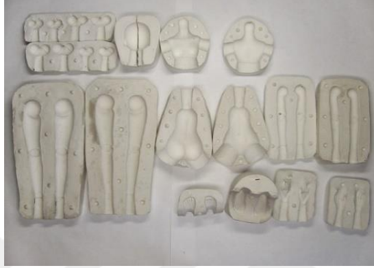
Görsel 2.23. Biblo yapımı için çok parçalı kalıp örnekleri ( https://oleum-13.livejournal.com/77196.html ), (Erişim tarihi: 7 Mart 2021)
