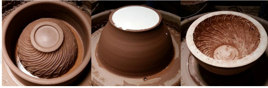
Görsel 2.20. Bir formun model kalıp alma süreci ( https://objectiveclay.com/blog/2016/1/11/throwing-molds-on-the-wheel ), (Erişim tarihi: 6 Şubat 2021)
