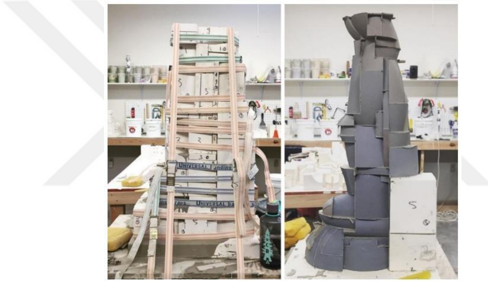
Görsel 2.31. Kyle Johns'un alçı kalıpları bir araya getirerek oluşturduğu kalıbı ve uygulama süreci ( https://www.instagram.com/kylejohnsceramics/?hl=en ), (Erişim tarihi: 21 Mart 2021)
