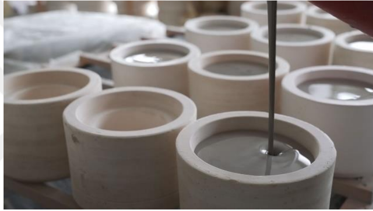
Görsel 2.29. İş kalıpları ve uygulama örneği ( http://designnation.co.uk/blog/dn-insight-sue-pryke-on-slipcasting-a-mug/ ), (Erişim tarihi: 7 Mart 2021)
