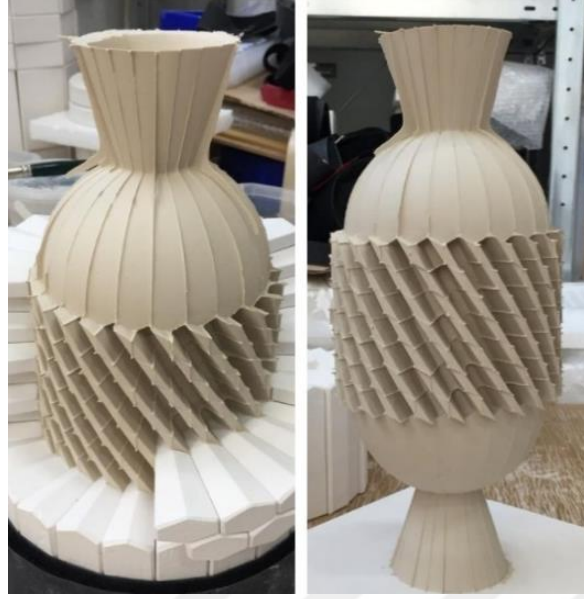
Görsel 2. 32. Joris Link'in birbirinin tekrarı alçı birimler ile bir araya getirdiği kalıbı ve uygulama süreci ( https://www.instagram.com/joris_link/?hl=en ), (Erişim tarihi: 21 Mart 2021)
