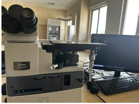
Şekil 9. Nikon ECLIPSE MA200 optik mikroskobu
