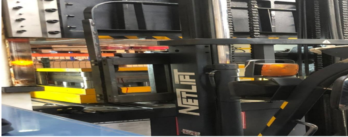
Şekil 6.3. Kalıp setlerinin pres makinesine bağlanması
