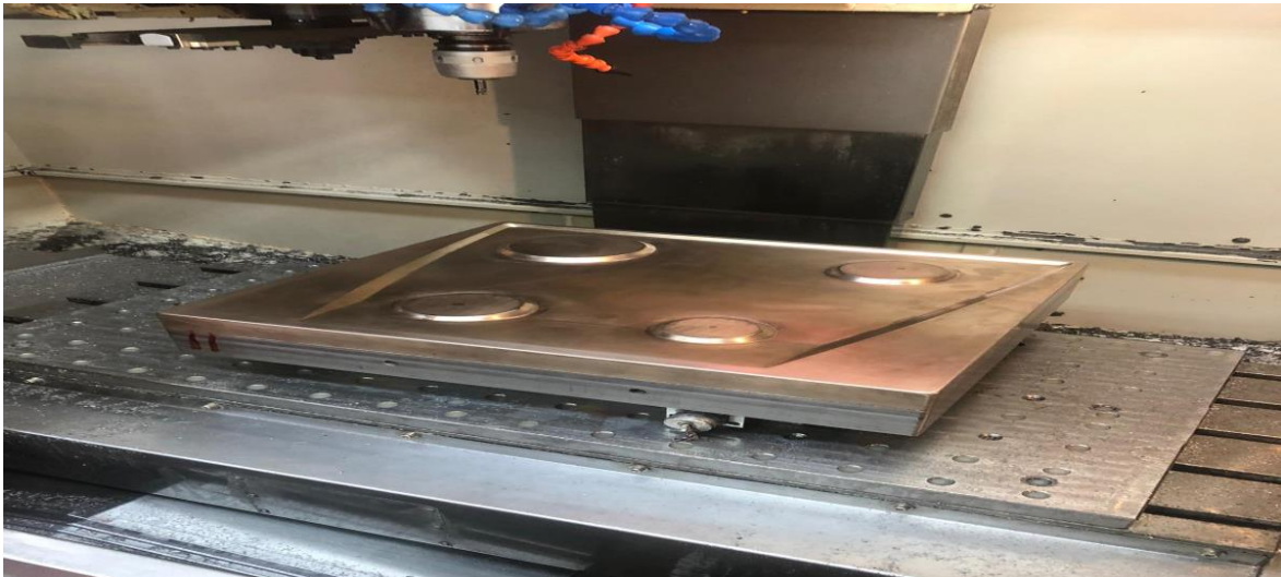
Şekil 7.4. Erkek kalıbın işleme merkezinde CNC torna tezgâhına bağlanması
