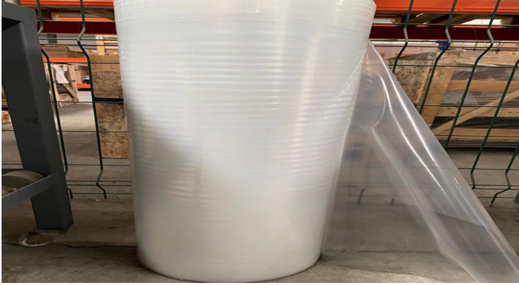
Şekil 7.14. Kalıp yağlayıcı (PTFE) Teflon film
