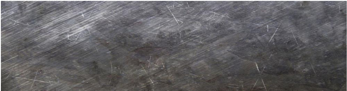
Şekil 5.1. Abraziv aşınmanın görünümü
