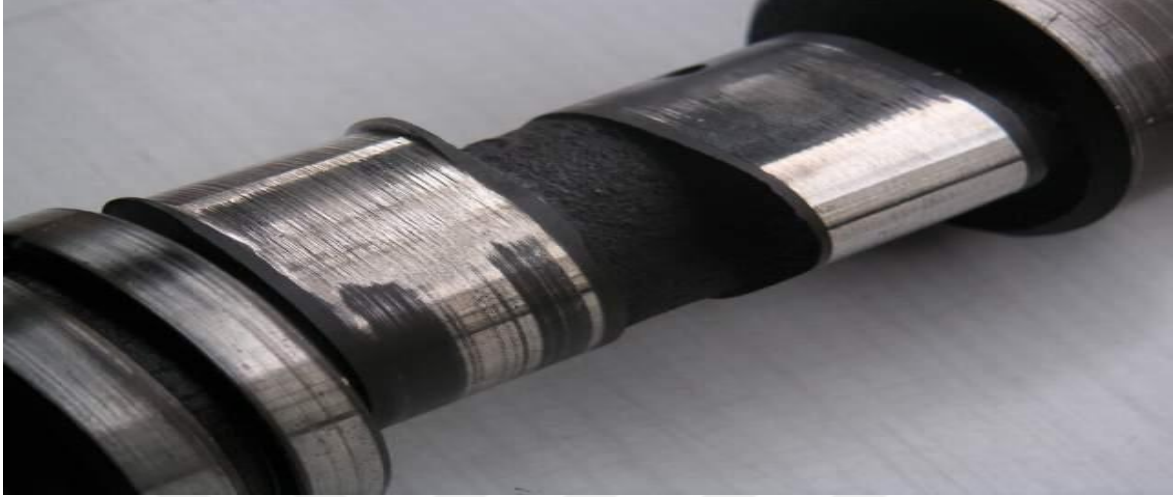
Şekil 5.3. Adeziv aşınmanın görünümü
