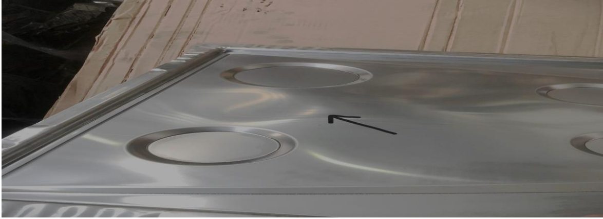
Şekil 7.1. DC04 7114 Kalite DKP sac malzemesinin pres baskı sonucu form görüntüsü
