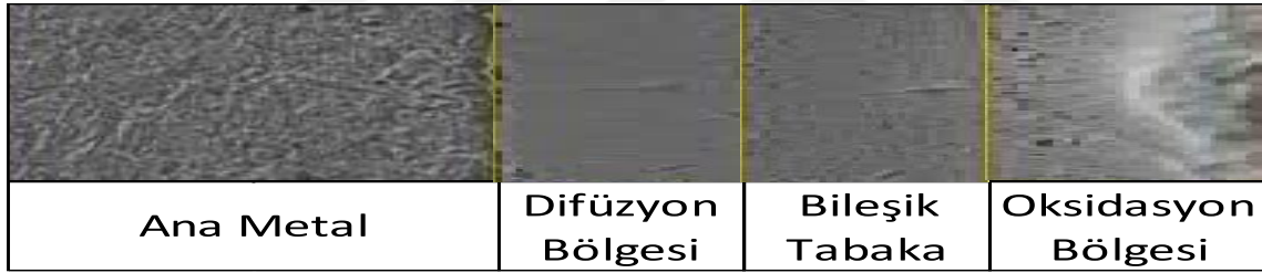
Şekil 5.2 Oksidasyon aşınmasının görünümü
