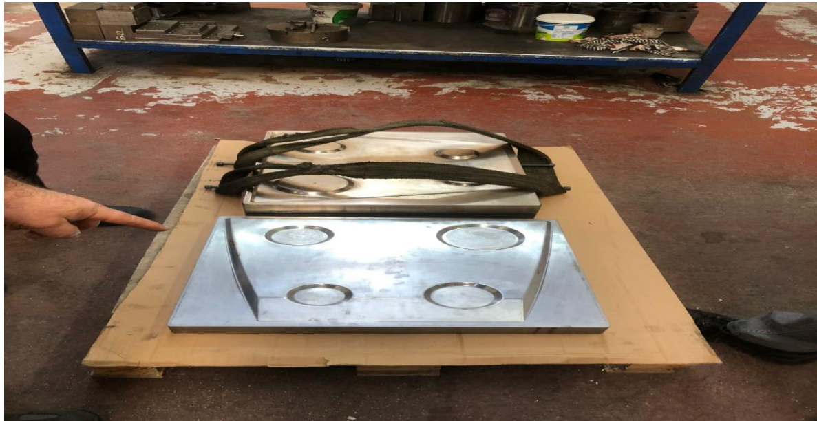
Şekil 6.6. 1.2379 soğuk iş takım çeliği erkek-dişi kalıp seti görünümü
