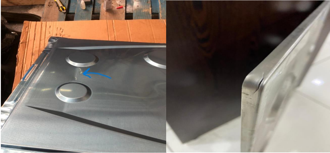
Şekil 7.2. 304 kalite İNOX ocak paneli pres baskı sonucu form görüntüleri
