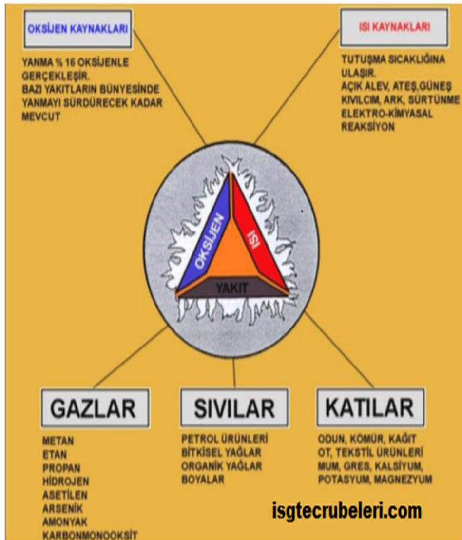
Şekil 2. Katı, sıvı ve gazlardan meydana gelen yangın türleri
