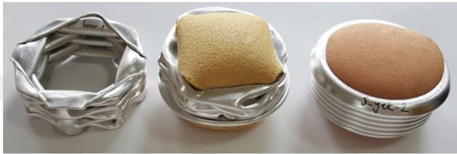
Şekil 4.20. Takviyesiz ve TYT numunelerin deney sonrası görüntüsü
