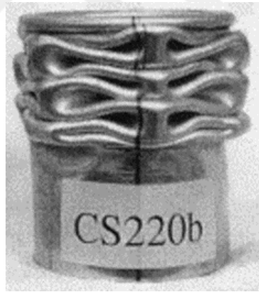
Şekil 2.5. a) Simetrik, b) elmas (üstten ve önden) katlanma modları [72]
