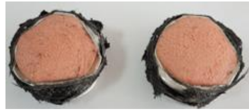
Şekil 4.45. 125 mm uzunluğa sahip çoklu takviye edilmiş numunelerin a) deney öncesi, b) sonrasına ait görüntüleri
