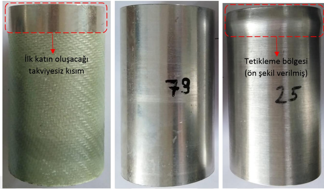
Şekil 4.40. Kısa elyaf sarılmış numune, takviyesiz tüp ve tetikleme işlemi uygulanmış takviyesiz tüp yapıların görüntüsü (soldan sağa)
