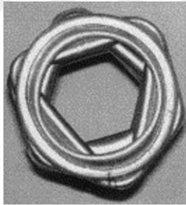
Şekil 2.5. a) Simetrik, b) elmas (üstten ve önden) katlanma modları [72]
