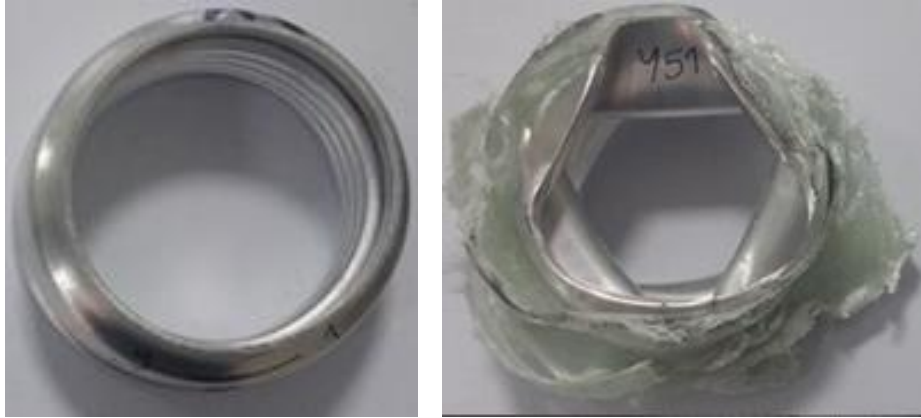
Şekil 4.29. Özdeş iki tüpte dışarıdan yapılan takviyenin katlanma moduna olan etkisi
