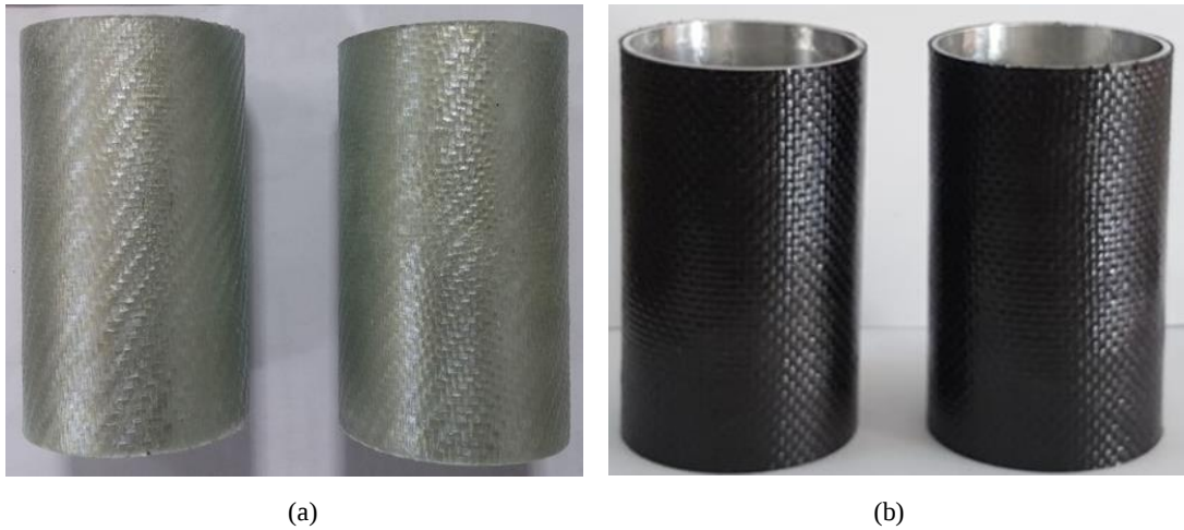
Şekil 3.11. a) Cam ve b) karbon elyaf kompozit takviyeli alüminyum tüpler
