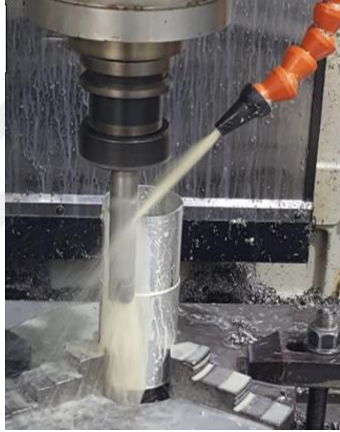
Şekil 3.6. Alüminyum boruların CNC dik işleme merkezindeki talaş kaldırma işlemi
