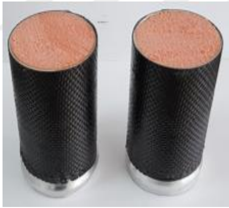
Şekil 4.45. 125 mm uzunluğa sahip çoklu takviye edilmiş numunelerin a) deney öncesi, b) sonrasına ait görüntüleri
