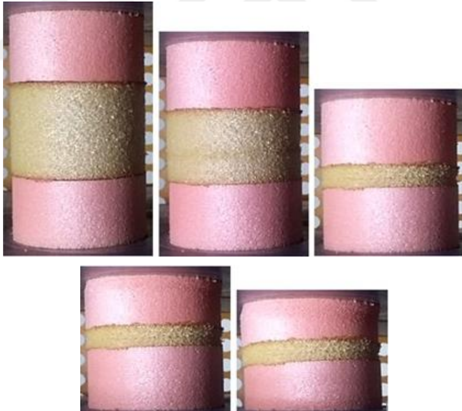
Şekil 4.16. Köpüğün deney sırasındaki deformasyon görüntüsü
