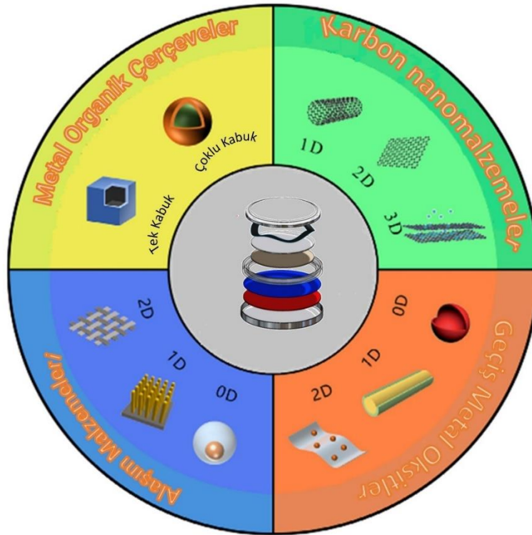
Şekil 2.4. Lityum iyon piller için birkaç temsili nano yapıli anot malzemesinin şematik diyagramı.
