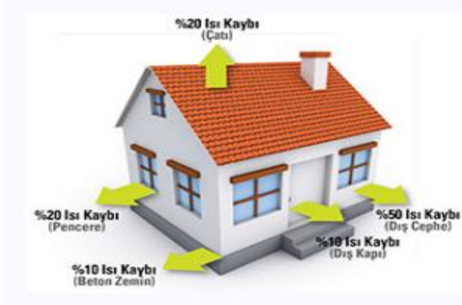
Şekil 3.10. Yapılarda ısı kayıpları [57]
