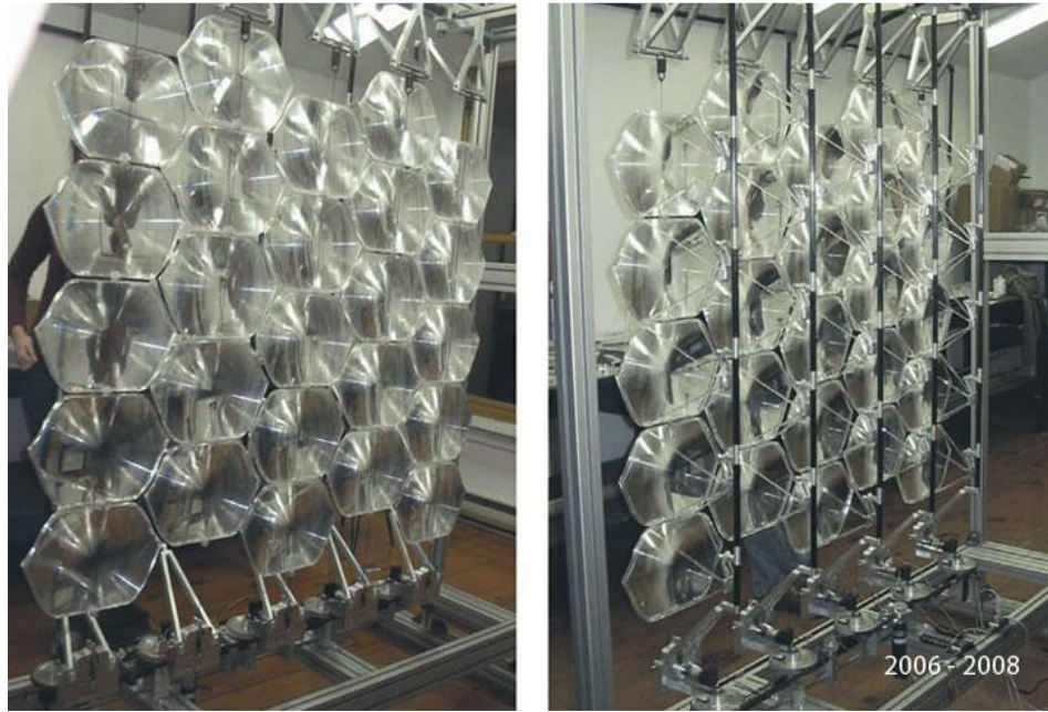
Şekil 4.4 CASE tarafından geliştirilen dinamik güneş cephesi (Sev ve Başarır, 2011)
