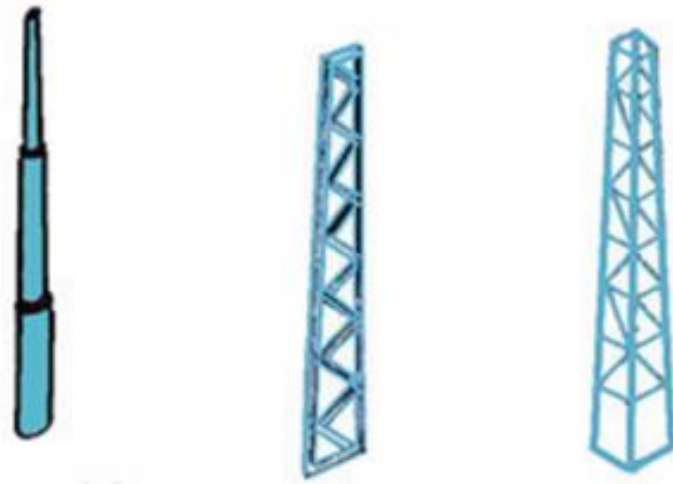
Şekil 3.1. Boru, A ve kafes kuleler
