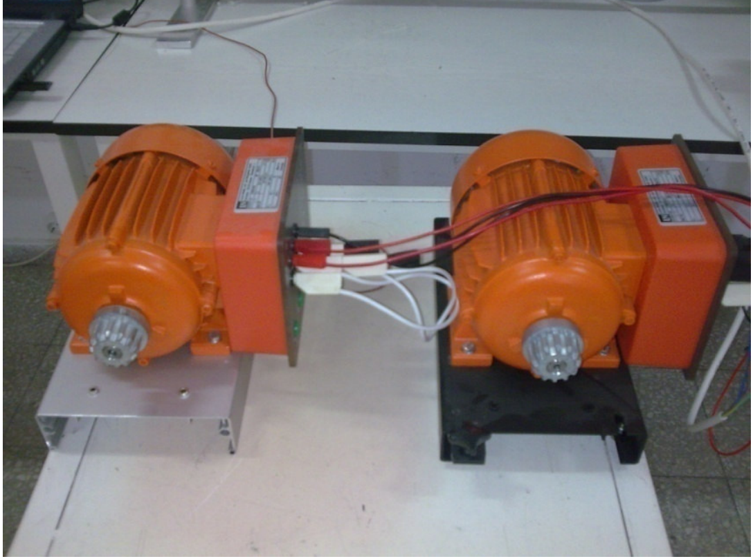
Resim 4.4. Kullanılan asenkron motorların görünümü
