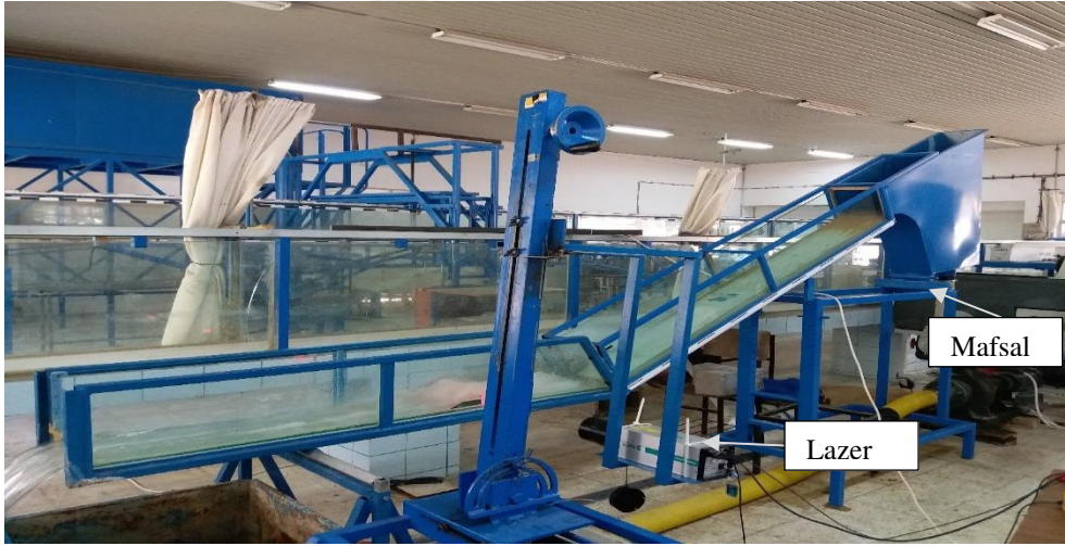
Şekil 4.1. Dolusavak ve enerji kırıcı yapı deney düzeneği
