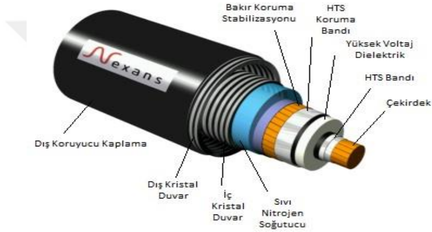
Şekil 9. Soğuk dielektrik süperiletken kablo tasarımı (Schmidt ve Allais, 2011).
