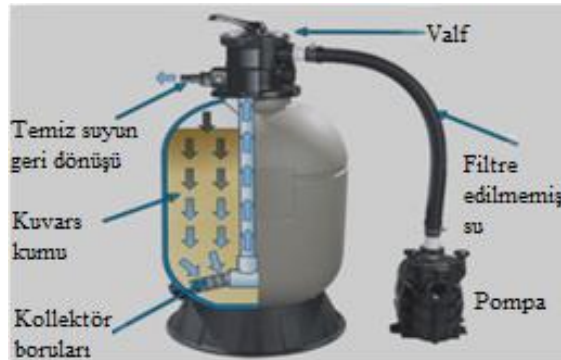
Şekil 2.5. Kum filtre çalışma prensibi.
