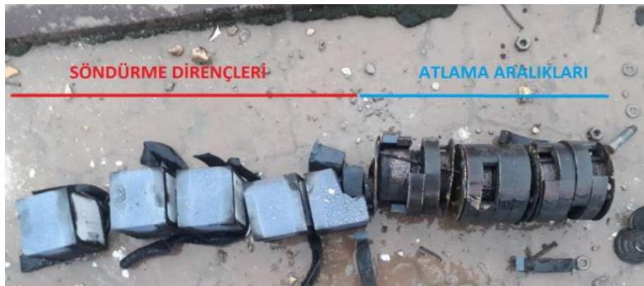
Şekil 3.8. Hasarlanan C faz parafudr içi (Doğanay, 2022).
