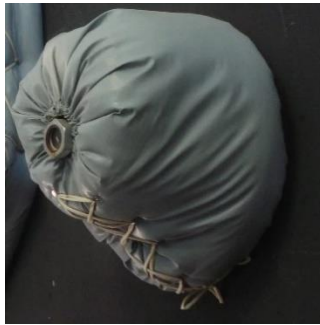
Şekil 5.27. Arka kapak için önerilen yalıtım yastığı
