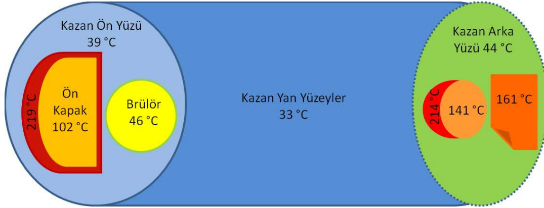
Şekil 5.19. Buhar kazanı yüzey sıcaklıkları
