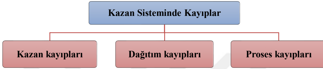
Şekil 5.1. Kazan sisteminde kayıplar
