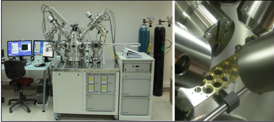
Resim 4.4. İkincil iyon kütle spektroskopisi (Hiden Analytical)
