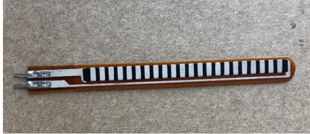
Resim 3.1 5.5 cm uzunluğunda esneklik algılayıcı.
